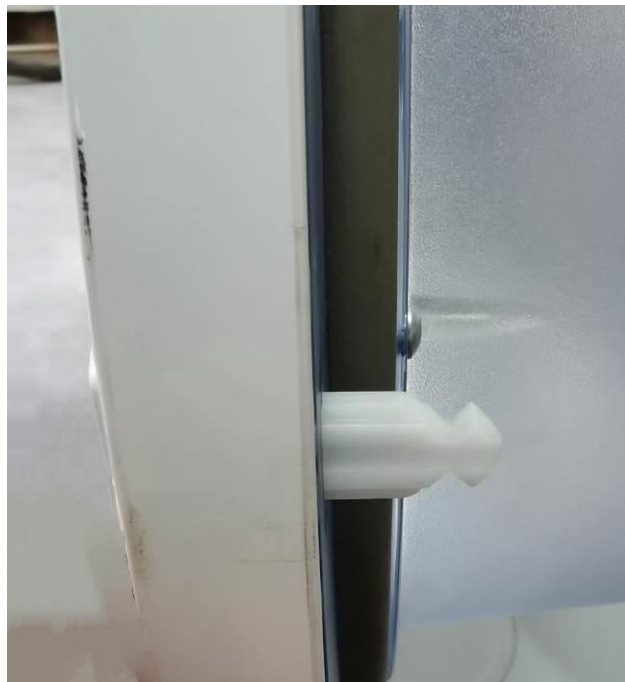
Door switch (T90-1, close the door and press the door switch)
